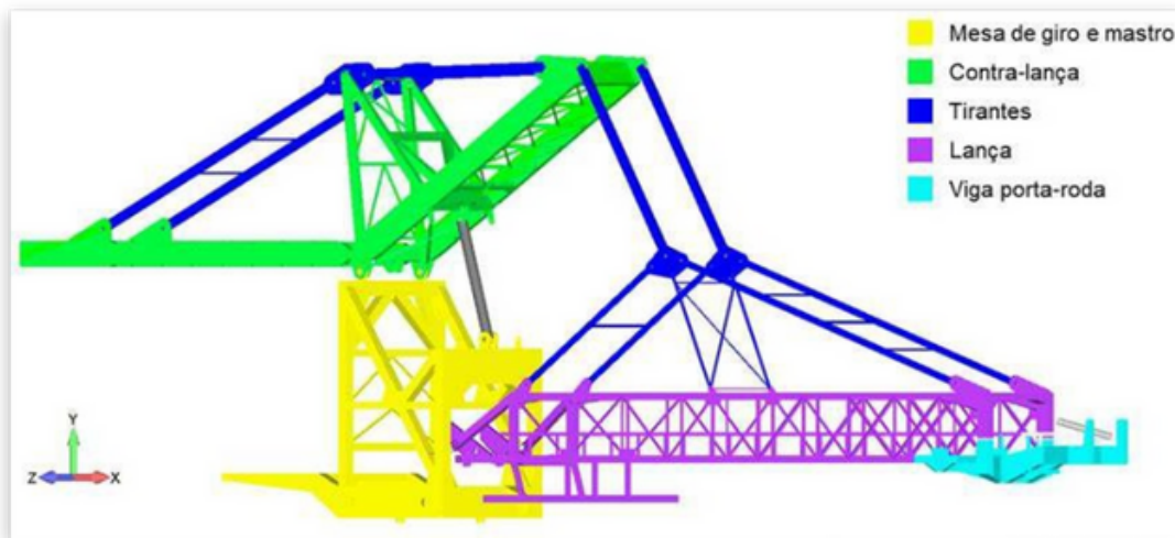
Modelo em elementos finitos para avaliação da parte superior da máquina durante os procedimentos.
