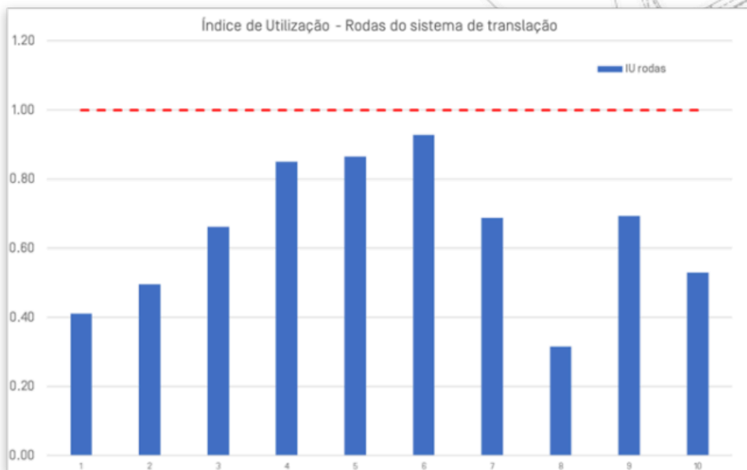
Índice de utilização das rodas do sistema de translação do transportador móvel.
