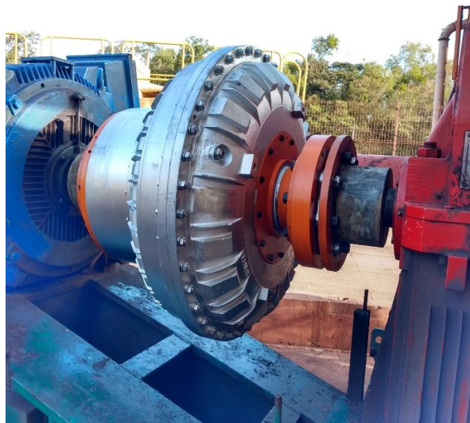
Figura 78: Novo acoplamento hidrodinâmico instalado.
