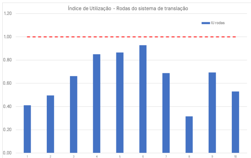
Figura 84: índice de utilização das rodas do sistema de translação do transportador móvel.
